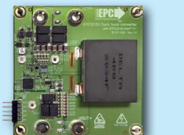
EPC9153: 250 W、高效、 薄型降壓轉換器
