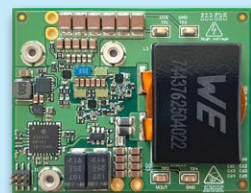
EPC9148: 48 V/19 V、超薄 型多級轉換器
